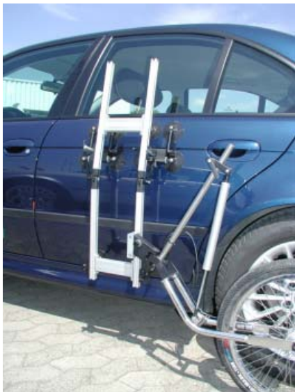
Seitliche Befestigung mit H-Adapter
