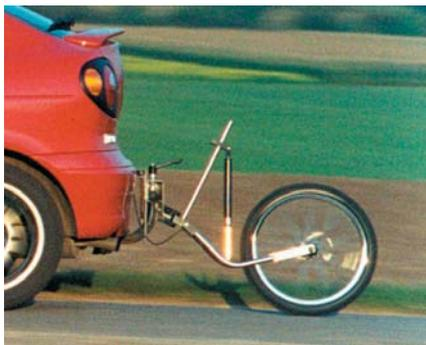
Für den Einsatz zur Streckenvermessung wird das Messrad mit einem speziellen Sensor und einer PC-Software geliefert, die unter MS-Windows lauffähig ist. Der Sensor übernimmt die Datenaufbereitung und kommuniziert mit dem PC-Programm über eine serielle Schnittstelle. (RS232 oder USB).
