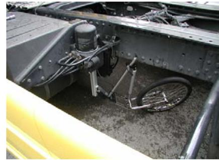
Messradbefestigung an der Mitteltraverse bei LKWs
